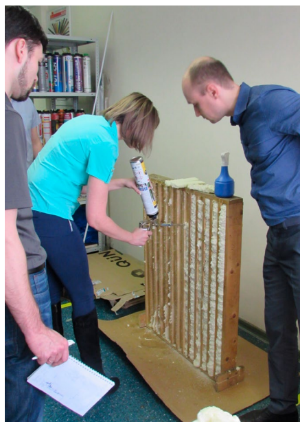
Продукт-менеджер департамента комплектующих для стеклопакетов и монтажа проводит сравнительные тесты монтажной пены
